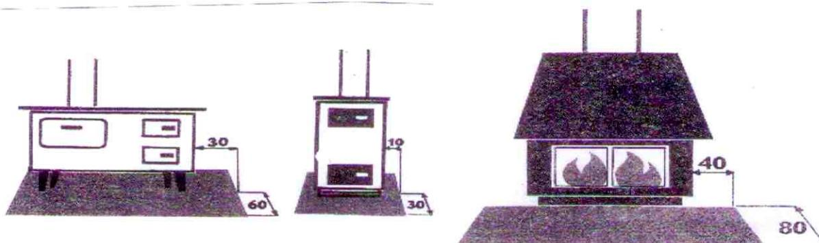
**3) dodržovat bezpečnou vzdálenost kouřovodu** od povrchu hořlavých stavebních konstrukcí:
